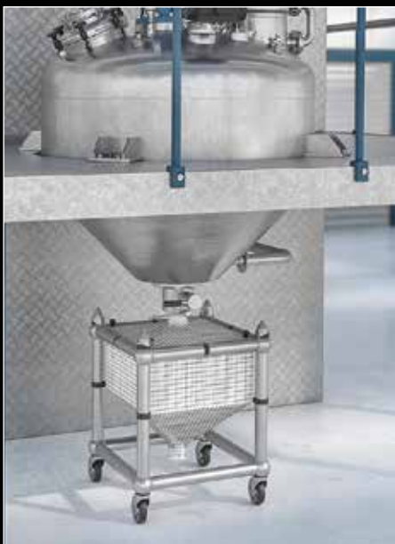
Entleerung aus Vakuumkontakt-trockner über APORT in ACBE-Transportgebinde
