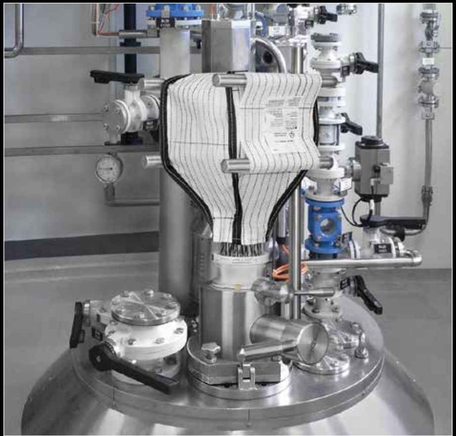
Single-use Reaktorbeschickung dank vakuum- & druckstoßfestem APORT
