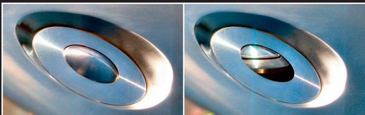
Ansicht vom Probenahmeventil von Behälterseite
